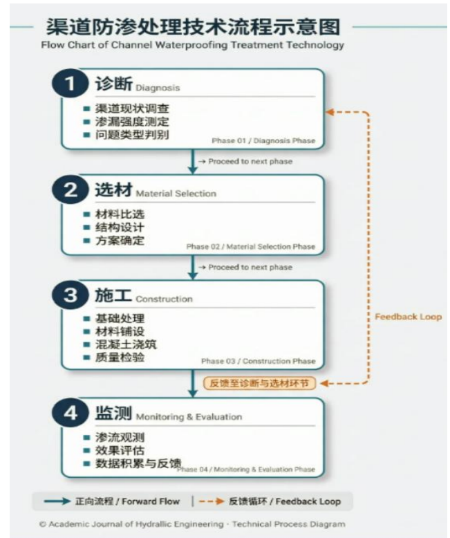
图1 平原灌区渠系渗漏治理工作流程示意
